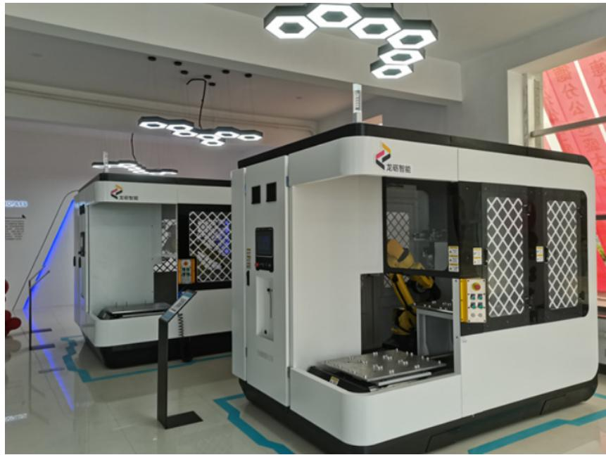
机器人的高柔性、高自动化等优点融入打磨领域，研发出浮动打磨工具，即柔性打磨。目前主要是分为闭环浮动机构、开环浮动机构、轴向浮动打磨工具、径向浮动打磨工具与机器人加力传感器五大类。柔性力控打磨系统通过内置传感器能实时侦测打磨压力、自身姿势、加速度等多种信息，并通过独有的重力补偿算法来确保任何姿势下，打磨设备与工件表面稳定接触，并保证打磨力的恒定。柔性力控打磨技术极大的弥补了国产机器人刚性不足及精度低的缺陷。高精度补偿且简单易用的操控，不只提高打磨的工艺效果，还能确保了打磨的一致性。力控的精度及反馈速度决定了产品的打磨效果。铸件打磨设备直销
